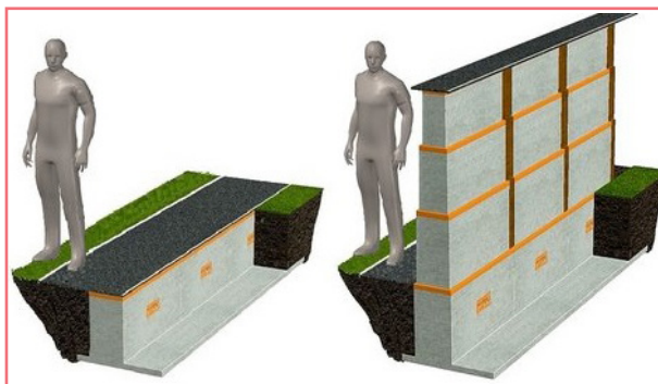
شکل ۲۰- کنترل سیلاب با استفاده از دیواره هوشمند
